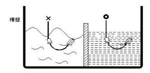
安装位置与流入口应保持适当距离以免被水冲击造成感应不正 确,若无法避免时可加装防护管改善。
