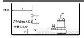
浮球动作长度a必须小于槽壁与电缆距离A; 浮球控制最低水位d 必须大于水位D。
