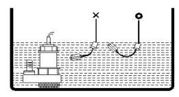
安装位置与抽水机入口应保持适当距离以免浮球开关被入水口 吸入。
