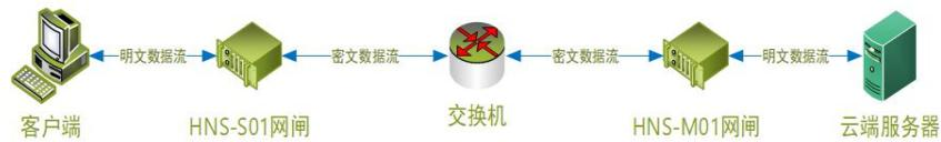
如上图，HNS-S01 客户端网闸向 HNS-M01 云端网闸发起密钥交换，HNS-M01 云端网闸返回 SM4 密钥，密钥交换过程使用 SM2 加密通信保证密钥的安全性，后续通信过程使用 SM4 密钥加解密数据。在实际通信过程中，客户端电脑或者云端服务器都可以作为通信的发起方，例客户端发起通信，HNS-S01 客户端网闸会对要发送的数据加密，然后通过交换机发送加密后的数据到公网，HNS-M01 云端网闸收到来自 HNS-S01 网闸的加密数据后根据客户端电脑的 ip 找到对应 HNS-S01 网闸的密钥对数据解密，解密后的明文数据传输到云端服务器。云端服务器向客户端电脑传输数据过程同上。
