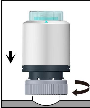
安装执行器：将螺母顺时针方向旋转装在阀门固定螺母上,直到手动旋转到位。
