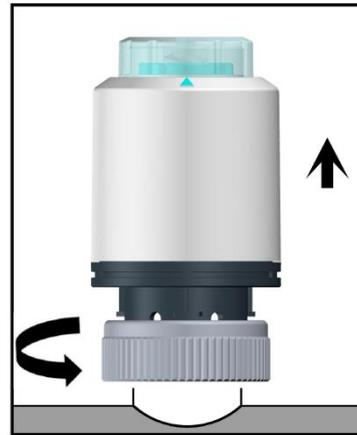
拆卸执行器：将螺母逆时针方向旋转,直至执行器取下。
