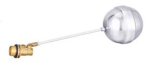
当水位上升到设定水位时, 浮球上升推动阀芯关闭阀门, 从而截断水流, 补水结束。
