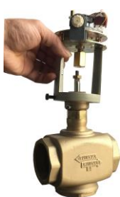
图 1: 打开执行器包装, 先将执行器盖子去掉, 用活扳手松开执行器支架侧面的螺栓。将执行器支架套入阀体阀杆处的安装环上
