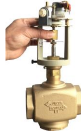
图 3: 将执行器伸缩杆与阀杆连接; 再用扳手拧紧阀杆上的螺母将刻度盘固定。
