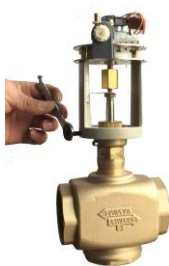
图 1: 打开执行器包装, 先将执行器盖子去掉, 用活扳手松开执行器支架侧面的螺栓。将执行器支架套入阀体阀杆处的安装环上
